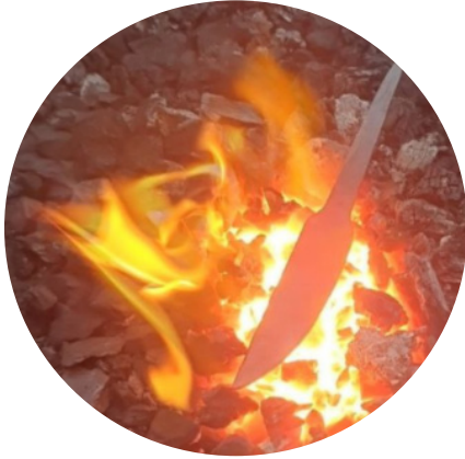
Perinteisen mallinen puukko taonnan jälkeen. Kuvassa on hyvin nähtävissä ruodon rakenne terässä.
